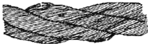
Рисунок 10.1. Обрывы и смещения проволок каната крестовой свивки
