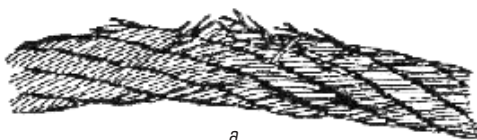
Рисунок 10.3. Обрывы проволок в зоне уравнительного блока: а – в нескольких прядях каната; б – в двух прядях в сочетании с местным износом
